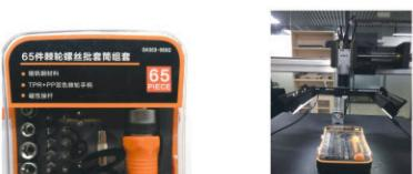
检测螺丝批套装上的印刷字符，使用两个条形光打光的效果图以及等效模型：
